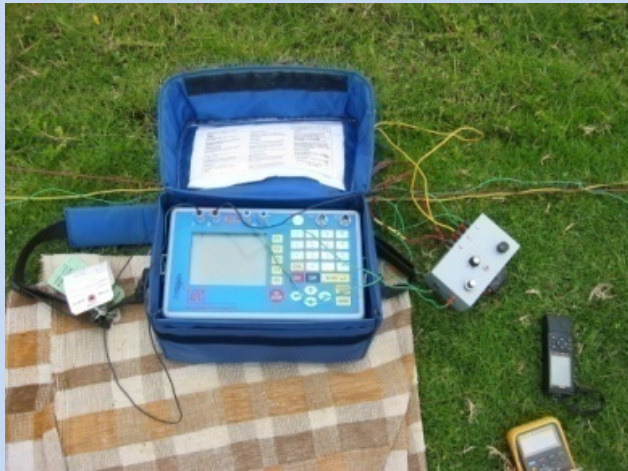
Figura 11. Vista cercana del equipo Transmisor-receptor marca Scintrex modelo SARIS utilizado en la prospección geoeléctrica; a un lado, de color gris, la caja interelectrónica y de color negro, el GPS marca Garmin modelo 12 xl
