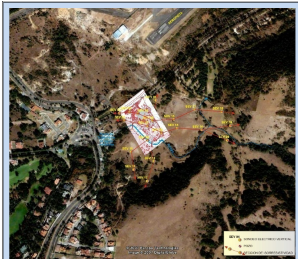
Figura 13. Ubicación de los SEV's realizados, así como de las secciones de isorresistividad real. La Imagen sobrepuesta corresponde a la zona de construcción del colegio, misma que es donde se realizaron los tendidos dipolares
