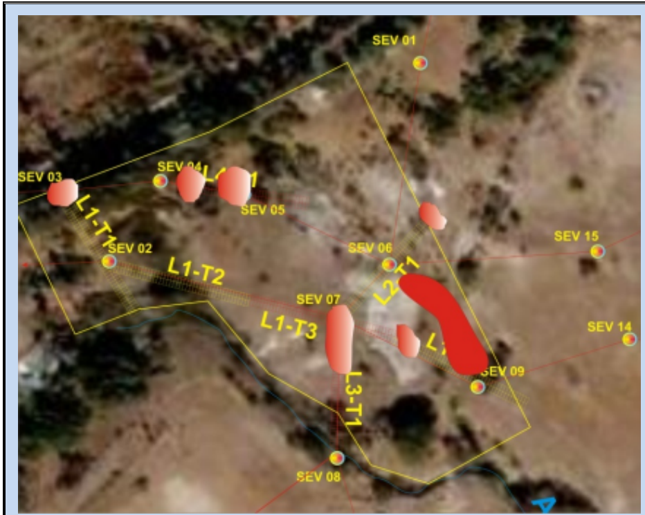
Figura 16. Sondeos Eléctricos y Tendidos Realizados.
