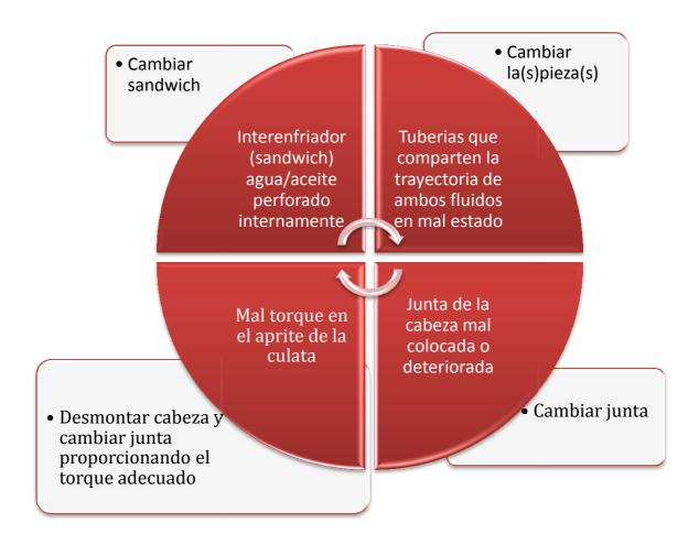
El calentamiento excesivo puede llevar a la destrucción de la maquina, por ello es indispensable siempre medir el nivel de refrigerante y corregir fugas en cuanto sean detectadas, si fuese el caso en que el motor ya se sobrecalentó bajo ninguna circunstancia debe de volver a ponerse en marcha.
