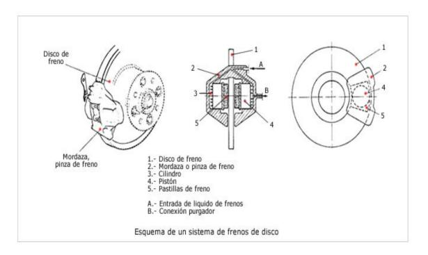
Por el interior de la mordaza (2) van situados los conductos por donde se comunica el liquido de freno a los cilindros (3), acoplando en (A) el latiguillo de freno y en (B) el purgador. El líquido a presión, procedente del circuito de frenos y que entra por (A), desplaza a los pistones (4) hacia el interior, aplicando las pastillas de freno (5) sobre el disco (1), las cuales, por fricción, detienen el giro del mismo.
