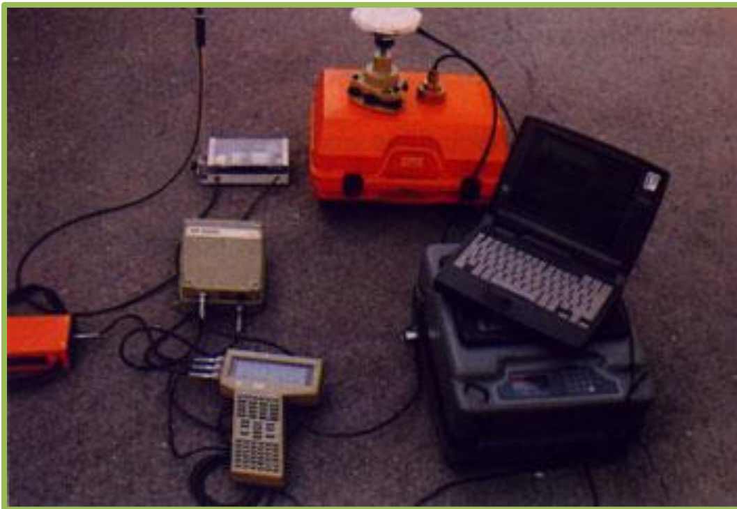
Fig. 2.9 Equipo para batimetría con GPS
