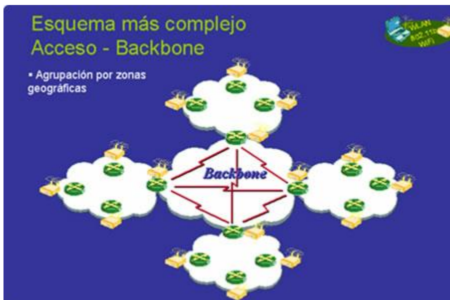
Figura 3.3 Esquema de una red MAN.
