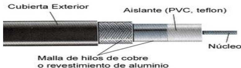
Figura 1.27 Composición del Cable Coaxial.
