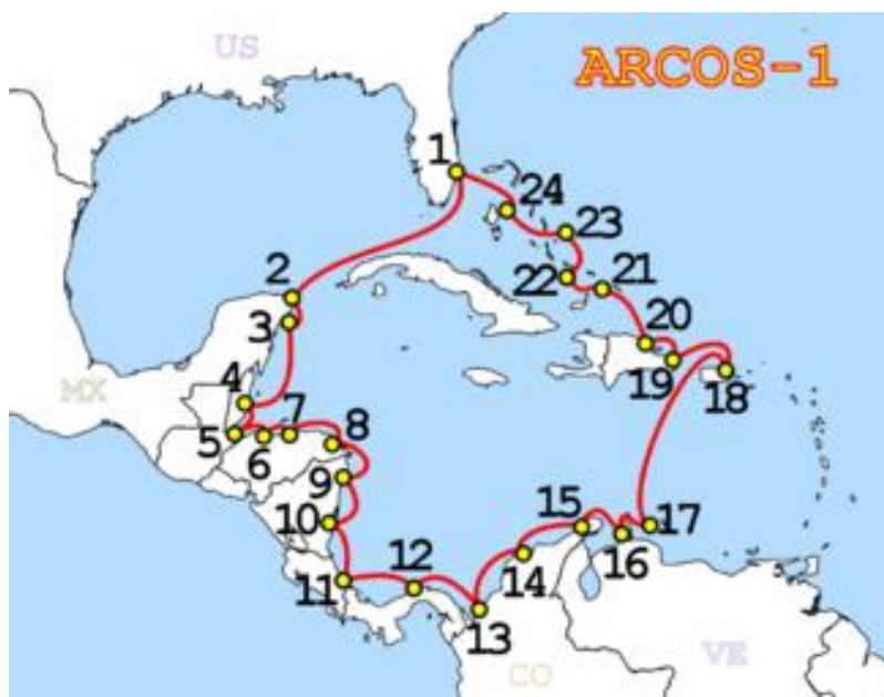
Figura 3.9 Mapa de la ubicación y puntos que conecta el cable submarino Arcos-1.
