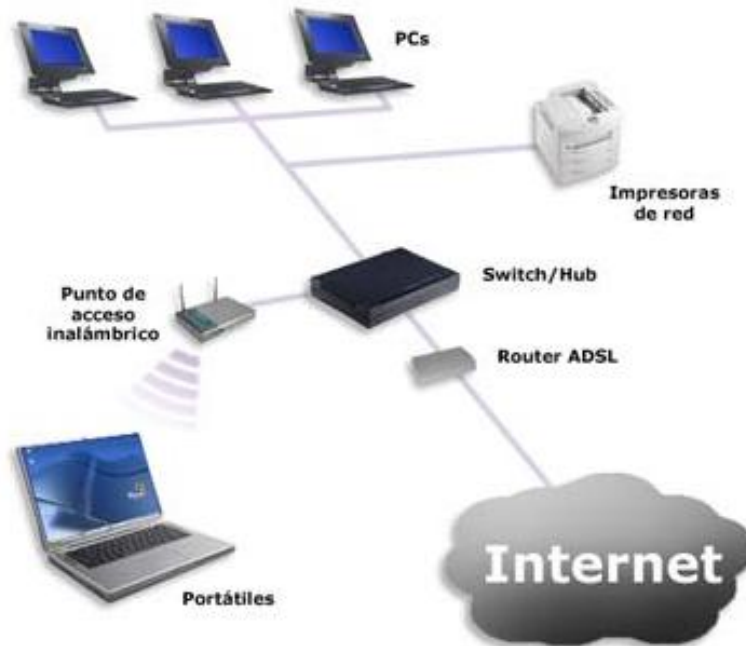
Figura 3.1 Diagrama de conexión de una red LAN
