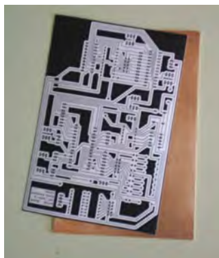
Figura 3.79: Tarjeta virgen y PCB a transferir.
