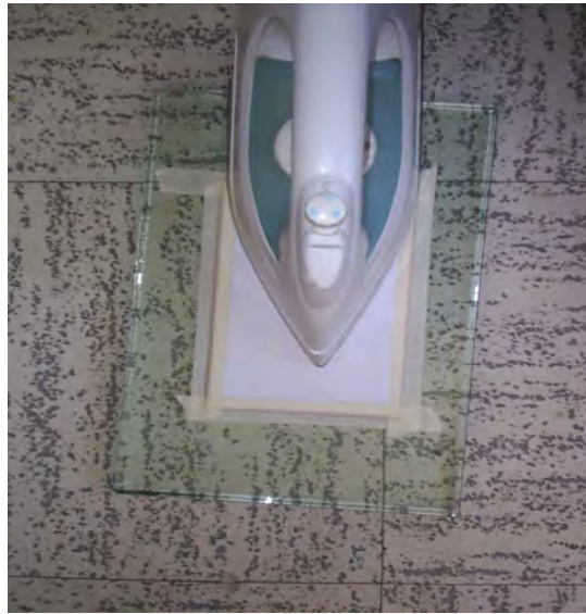
Figura 3.80: Traspaso del PCB.
