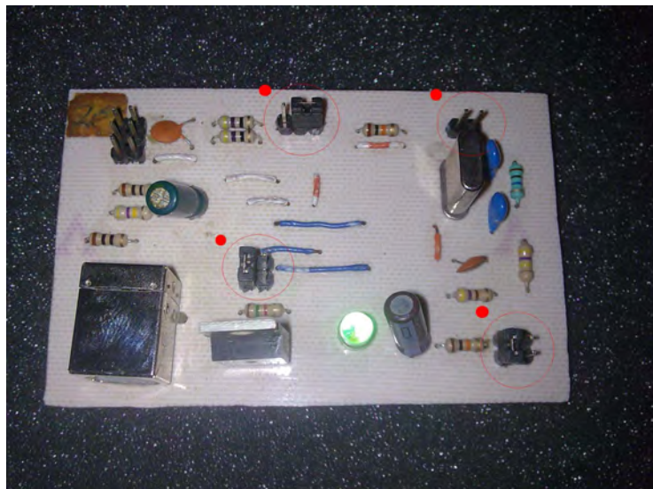
Figura 5.9: Ajuste de jumpers.
