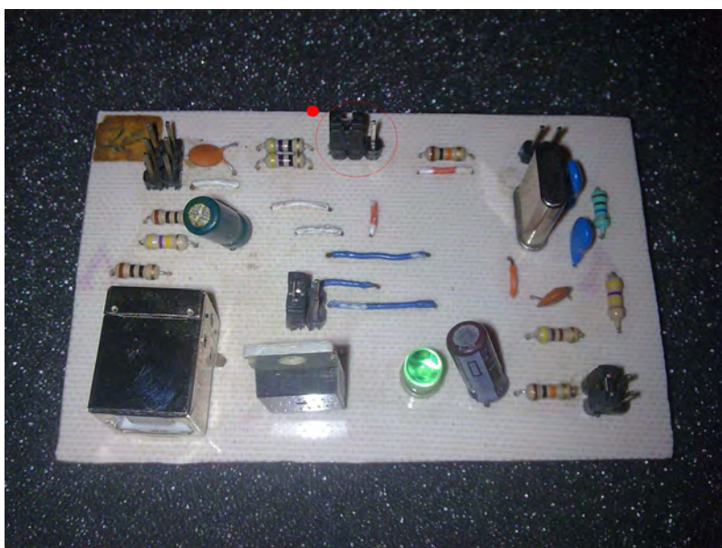
Figura 5.11: Colocación de jumpers para la grabación a 3 voltios.
