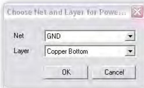
Figura 3.63: Establecer el Power Plane.
