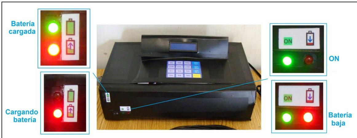
**Figura 7.14** LED's indicadores de energía en el electrocardiógrafo.
