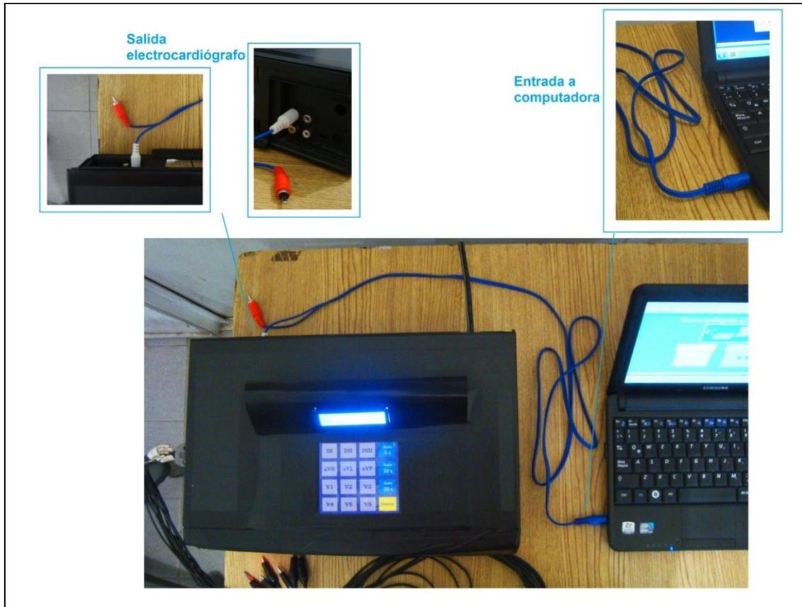
Figura 8.4 Conexión entre el electrocardiógrafo y la computadora mediante un cable de audio.
