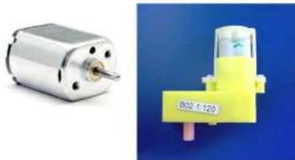
Fig. 2.31 Motor DC arriba y moto-reductor tipo gorila a la derecha
