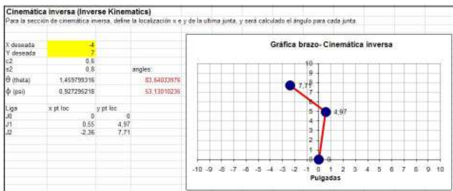
Fig. 4.34 Hoja de cálculo para Cálculos del diseño de brazos robóticos. Cinemática inversa. www.societyofrobots.com
