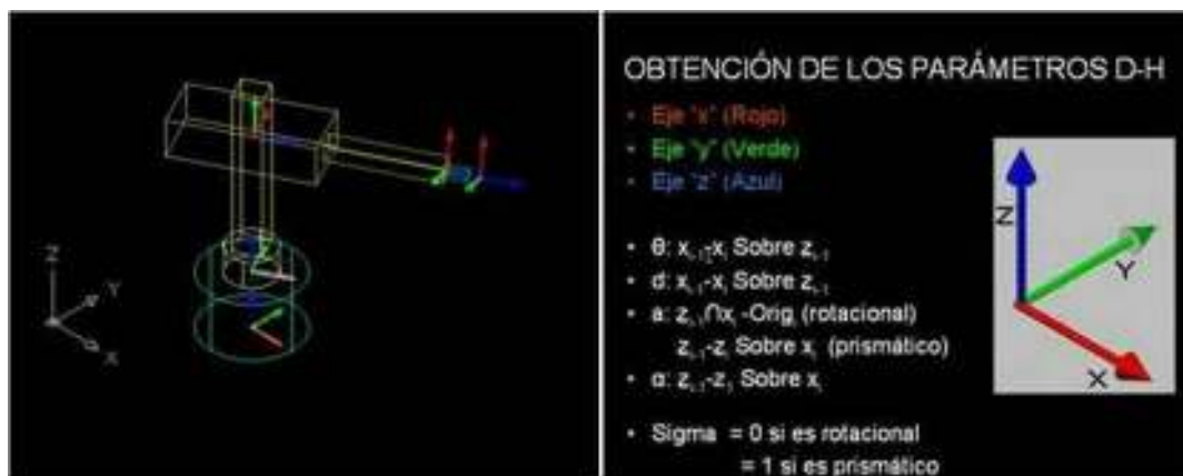
Fig. 4.22 Diagrama y parametrización del ejemplo de diseño en algoritmo D-H
