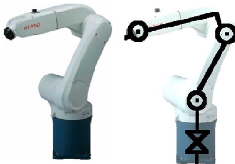
Fig. 4.21 Demostración de la relación entre el FBD y los símbolos del Convenio Denavit-Hartenberg
