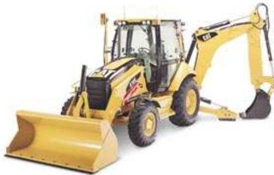
Figura 5.22. Rotoexcavadora y cargadora 416
