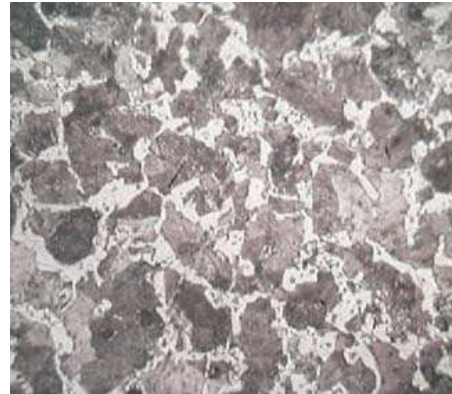
Figura 5.8. Corte transversal en zona alejada de la falla a 400
