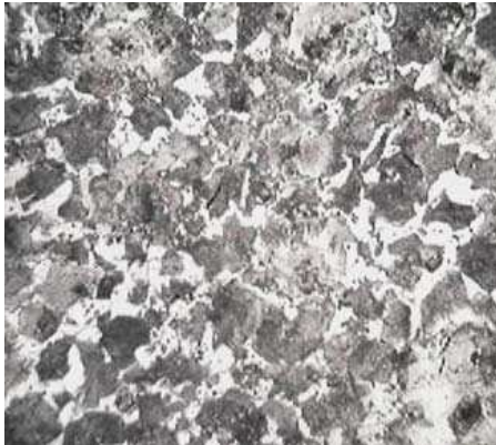
Figura 5.7. Corte transversal en la zona de la falla a 400X
