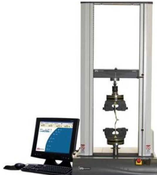
**Figura 67.** Vista frontal del Sistema de ensayo de sobremesa universal y doble columna, [44].
