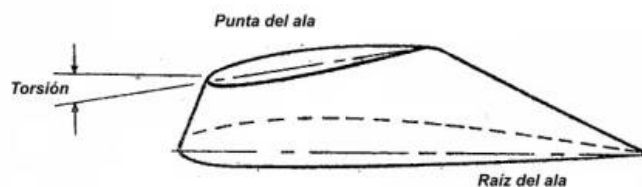
Fig. 4. Vista lateral de un ala ahusada con torsión geométrica
