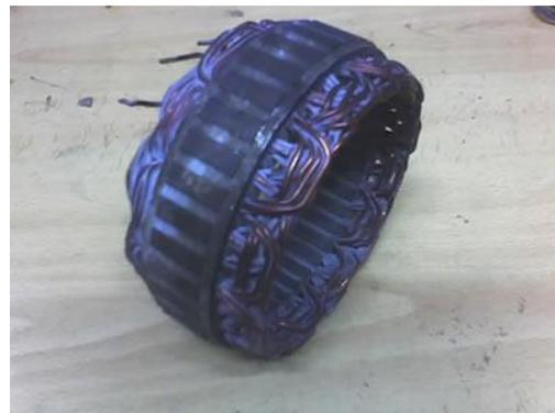
Fotografías de un estator inducido de un alternador de automóvil
