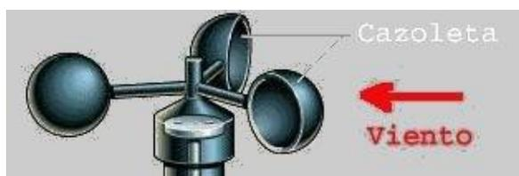
Anemómetro del tipo cazoleta, es el diseño más común debido a que no necesita mecanismo de orientación
