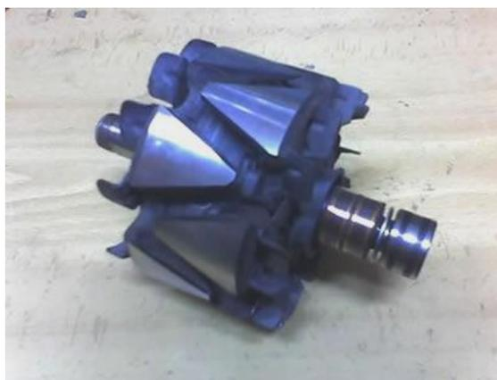
Fotografía de un rotor inductor de un alternador de automóvil
