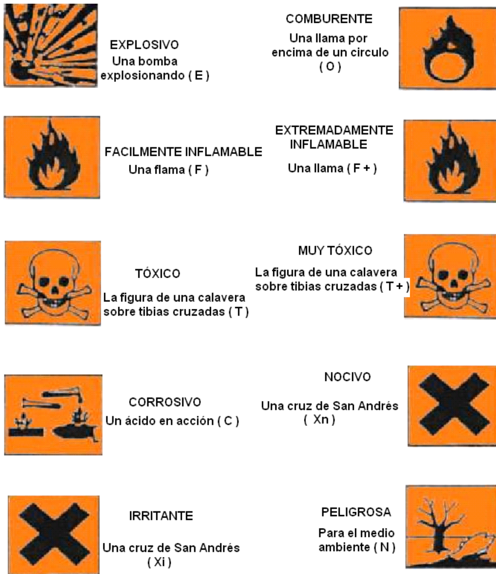
FIGURA 1A: PICTOGRAMAS DE IDENTIFICACIÓN DEL TIPO DE PELIGRO QUE PUEDEN PRESENTAR LAS DIVERSAS SUSTANCIAS QUÍMICAS.
