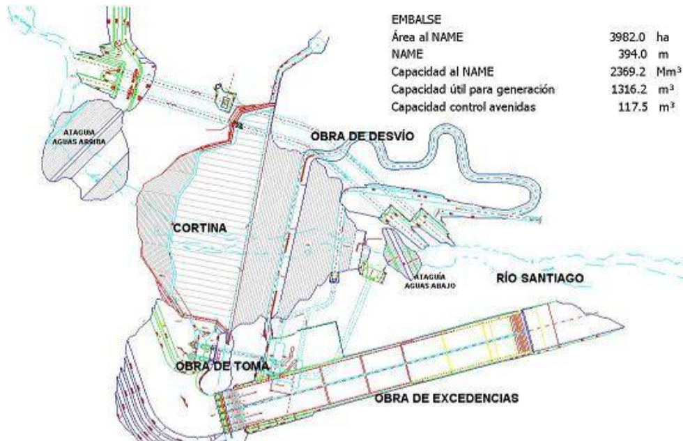
Figura II.10. Planta general de la C.H. El Cajón.
