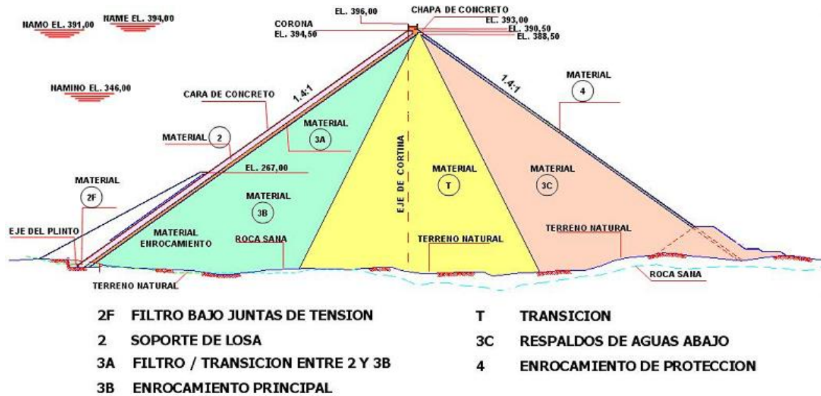
Figura II.11. Sección máxima de la cortina, indicando la zonificación de los materiales.
