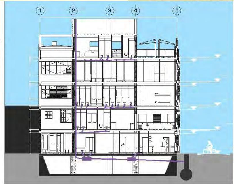
Para la reutilización de las aguas grises tenemos el siguiente corte donde se explica de manera general la captación y su proceso de purificación, la cual complementa con el corte de reutilización de aguas grises.
