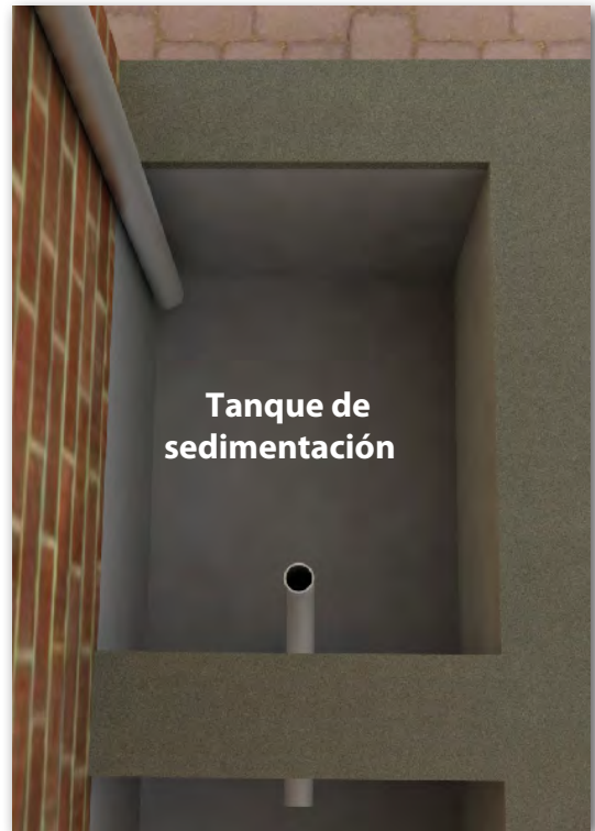
Figura 4|05. Tanque de sedimentación.
