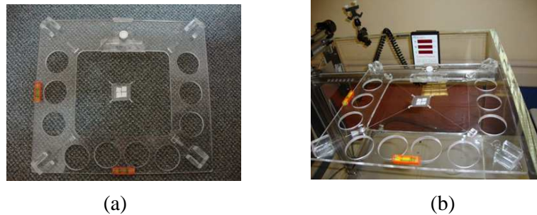
Figura 3.3. (a) Soporte de acrílico, (b) Soporte de acrílico acoplado al maniqué PTW
