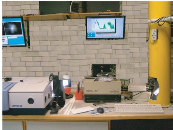
Figura A.3: Espectrómetro OPAG22 y VERTEX recibiendo la luz solar en el interior del laboratorio durante el proceso de medición.
