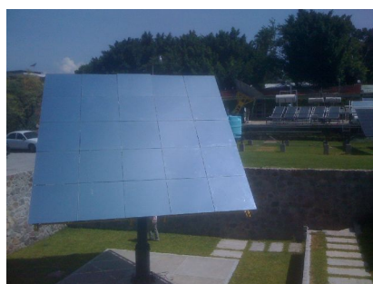
Fig. 1.13b. Helióstato sin separación
