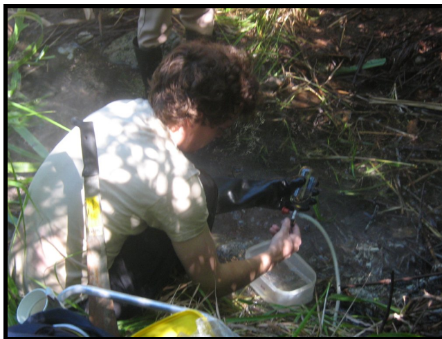
Fig. 2.1. Muestreo del gas burbujeante de AS con el frasco de Giggenbach en Junio-2010.
