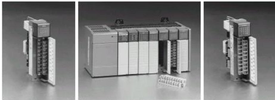
En la figura 1.2 se muestra a los extremos módulos de entrada/salidas habituales para la conexión de señales externas, al centro del dibujo se observa el PLC (SLC 500) completo con su chasis, fuente de voltaje, procesador y módulos de entrada / salida.
