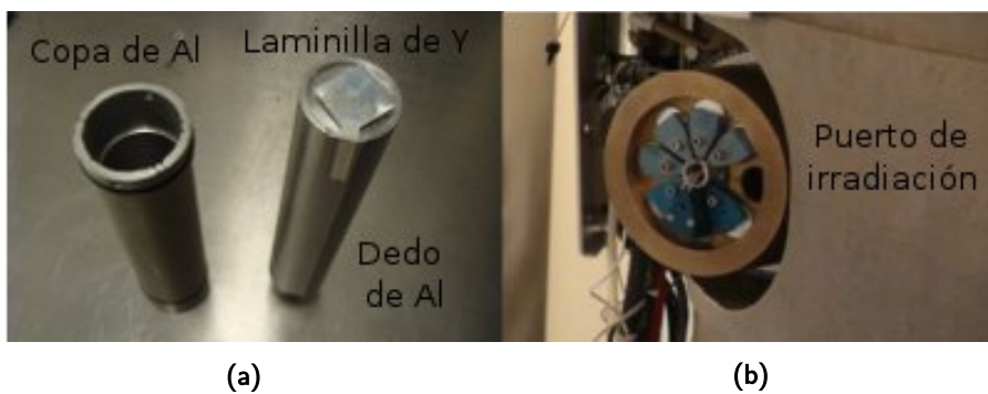
Figura 3.6: (a) Colocación de la laminilla de Y sobre el dedo de Al, sujeta con una cinta especial resistente a altas temperaturas. (b) Puerto de irradiación, en donde es colocada la copa de aluminio, en la cual se encuentra el dedo de Al con la laminilla de Y.
