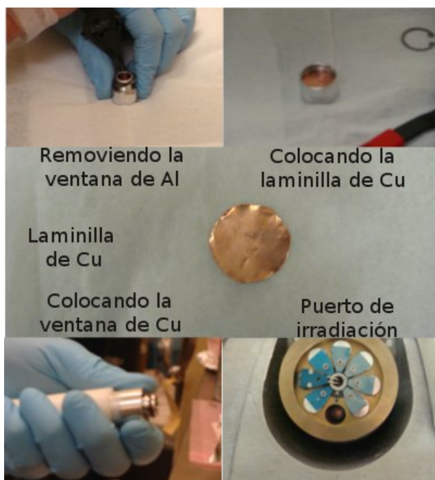
Figura 3.9: Cambio de la ventana de Al por una ventana de Cu para el tanque de vacío.
