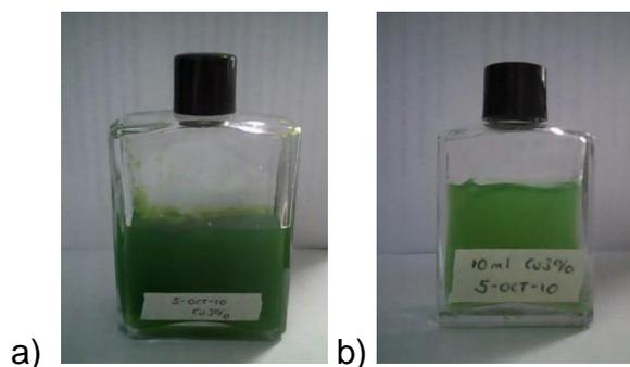
Fotografía 3. Gel de Cu-orgánico-SiO<sub>2</sub>-ZrO<sub>2</sub> al 3% en peso: a) Temperatura ambiente y b) Temperatura a 70°C.
