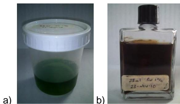
Fotografía 2. Sol y gel de Cu-orgánico-SiO<sub>2</sub>-ZrO<sub>2</sub> al 1% en peso: a) Temperatura ambiente (sol) y b) Temperatura a 70°C (gel).
