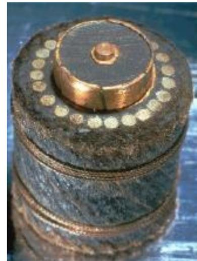
Figura 1.12. Parte del cable trasatlántico..
