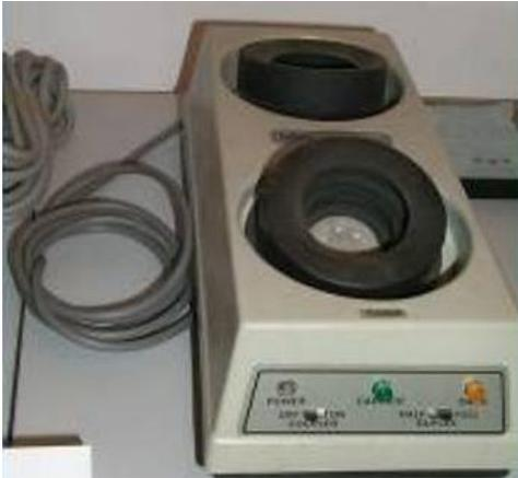
Figura1.14. Modem con acoplamiento acústico.
