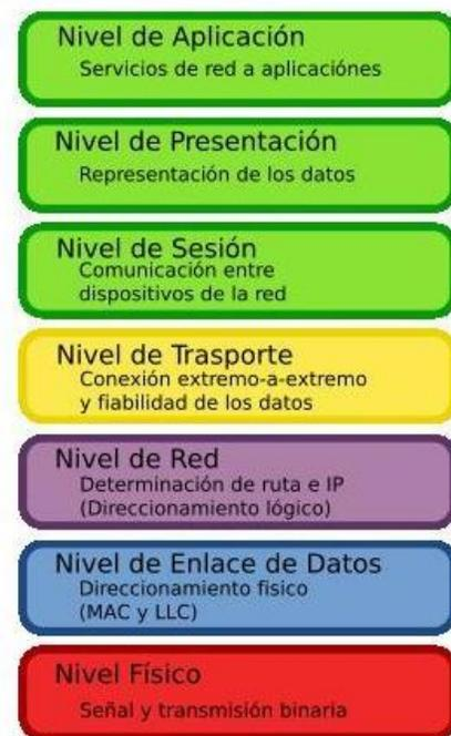
Figura 2.7. Capas del modelo OSI.
