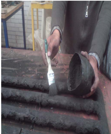
PINTADO DE LOS TUBOS
