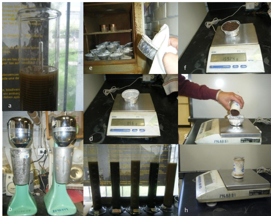
Fig. 16 Determinaciones en laboratorio de parámetros físicos de suelo. Textura (a, b y c); Densidad aparente, porosidad y % de humedad (d, e, f, g, h). (Fotos tomadas por Mitzi Y. Ayala C.).
