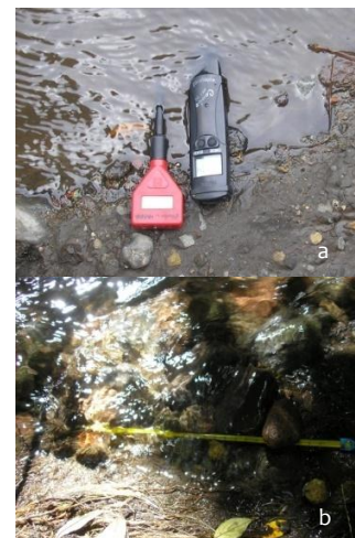
Fig. 13 Determinaciones In situ de parámetros físicos. a) pH, conductividad y STD, b) temperatura. (Fotos tomadas por Mitzi Y. Ayala C.)
