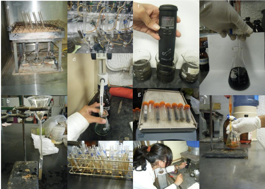
Fig. 17 Determinaciones en laboratorio de parámetros químicos del suelo. Nitrógeno (a, c, d), Fósforo (b, e, g), Conductividad eléctrica (f, h) y MOS (i, j). (Fotos tomadas por Mitzi Y. Ayala C.).
