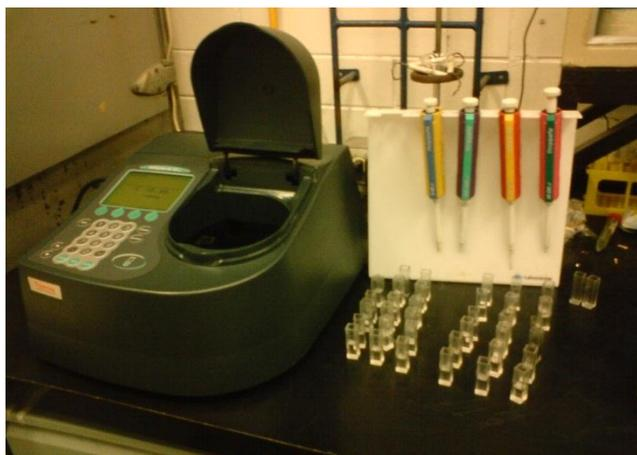
**Figura 3: Espectrofotómetro Genesys 10 UV-visible, las celdas y las micropipetas usadas en la experimentación.**
