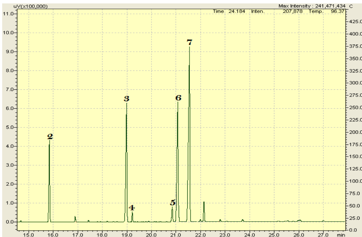
Figura 17. Cromatograma del análisis de AGs del Chile Piquín. Identificación de los picos cromatográficos como en la Figura 11
