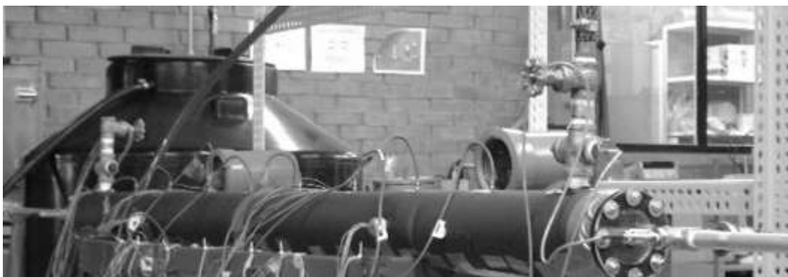
Figura3.19: Equipo ensamblado para calcular experimentalmente los CCTC
