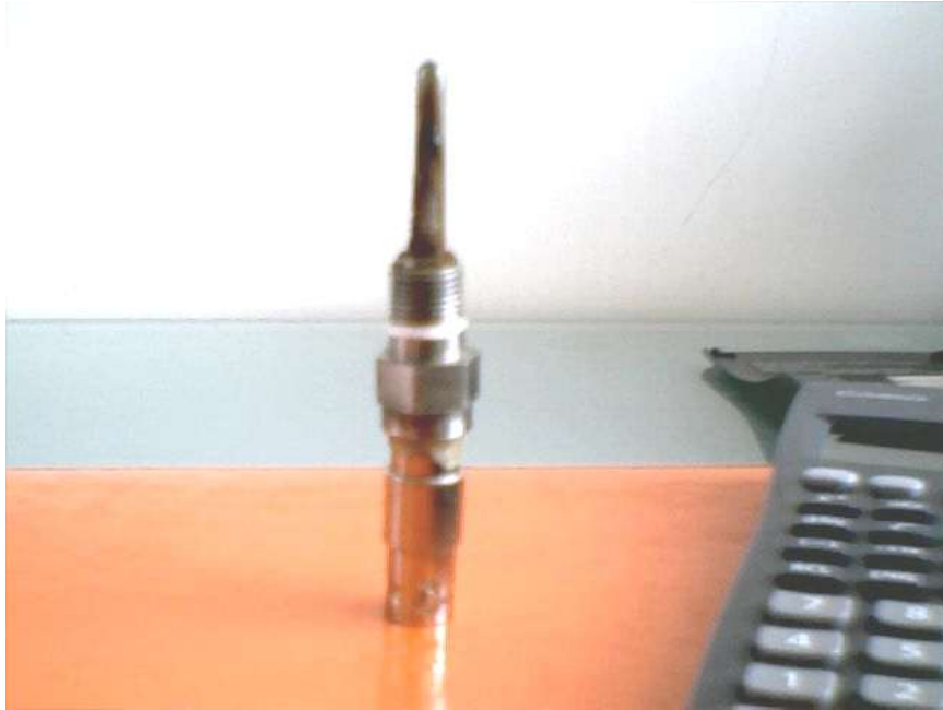
Figura 5.9: Termistor oxidado de la sección de prueba.
