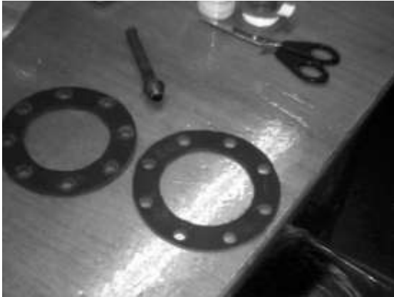
Figura 3.17: Empaques para las tapas extendida para tubo externo.
