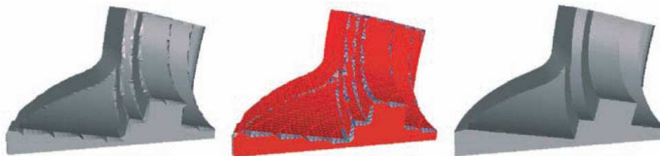
Figura 2.5: Malla triangular (imagen izquierda) reconstruida por mejoramiento de crestas usando Feature-Remeshing . Las regiones suaves y los triángulos de frontera son identificados (imagen central). Como resultado, se obtiene una transición con curvas suaves definiendo la superficie (imagen derecha). Fuente: De Floriani y Spagnuolo [2008].
