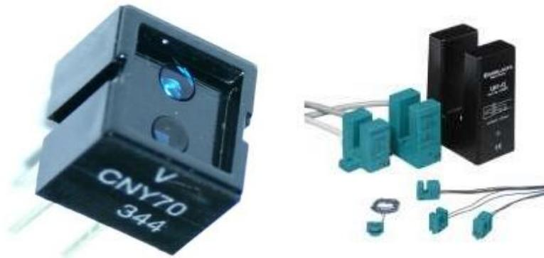
Figura 4.9 Sensores por reflexion.
