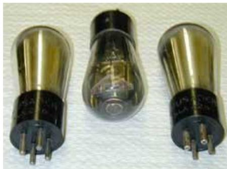
Figura 3.5 Tubos de vacío.
