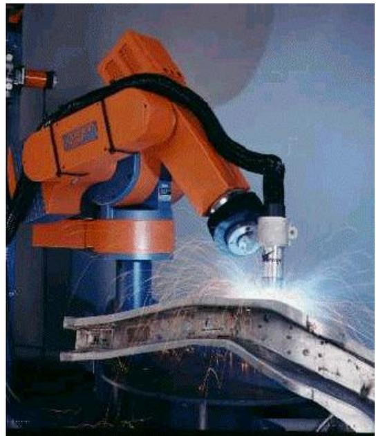
Figura 2.4 Brazo aplicando soldadura.
