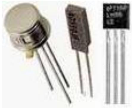
Figura 4.22 Sensores de temperatura (CI)
