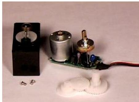
Fig. 4.2 Servomotor desarmado
