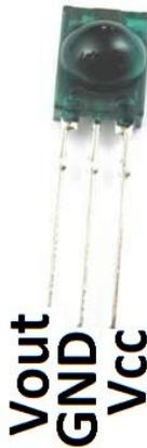
Figura 4.8 Pinout del receptor infrarrojo.
