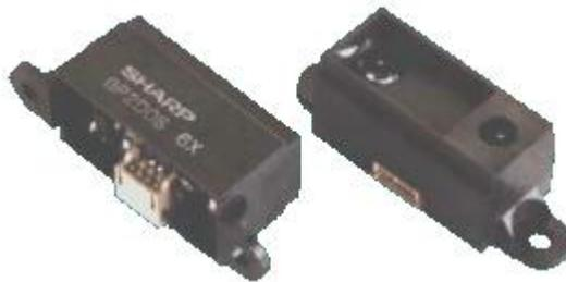
Figura 4.18 Sensores de distancia por infrarrojos.
