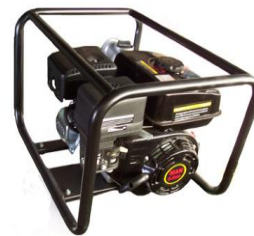
Bomba de agua auxiliar de gasolina
