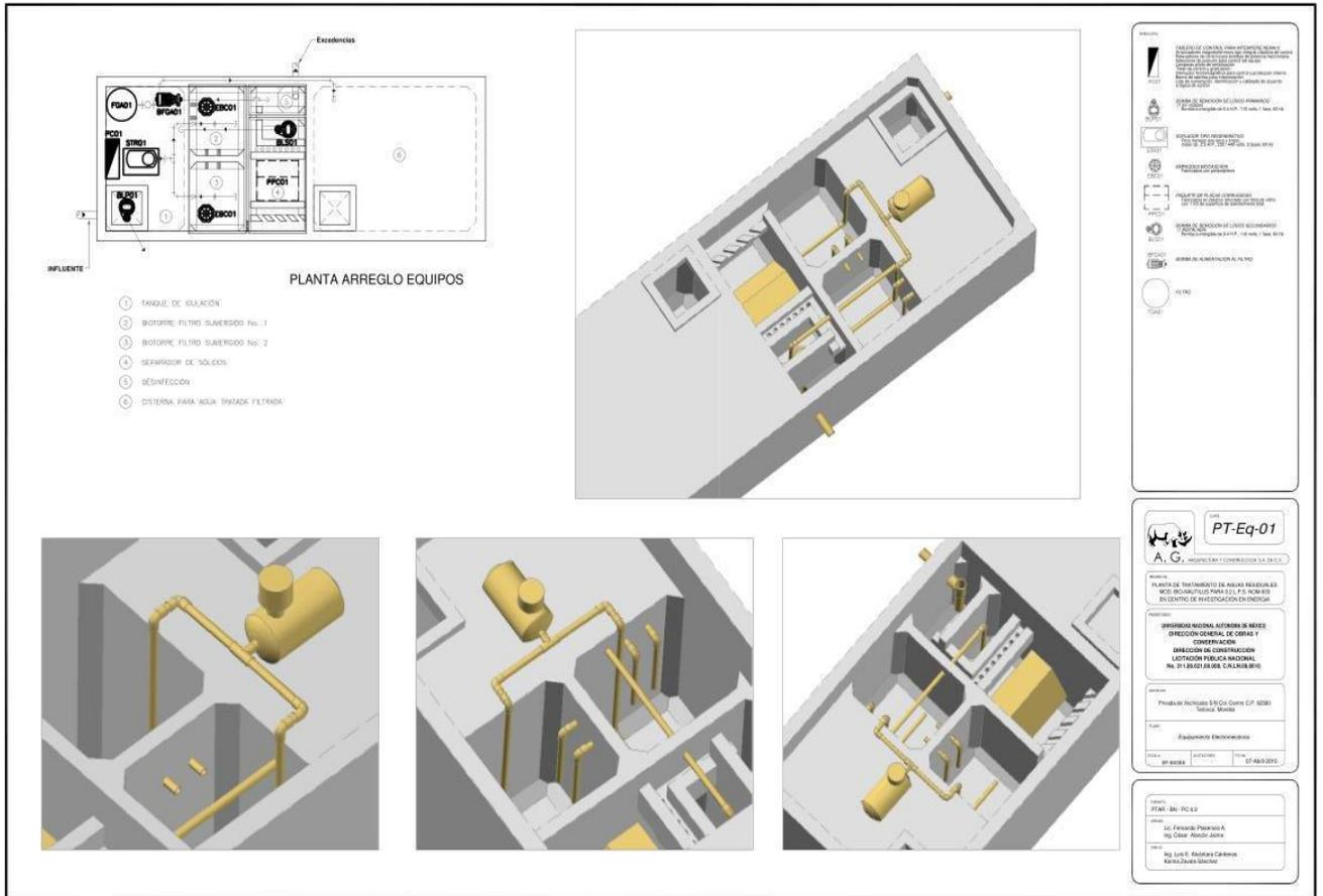
**Figura 3.2** Plano y axonometría de equipo y tuberías internas.
