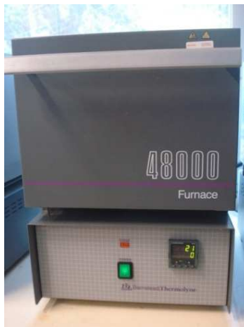
Figura 2.1 Mufla Barnstead Thermolyne 4800 utilizada en la activación de las muestras de hidrotalcita nativa y en la preparación de MgO.
