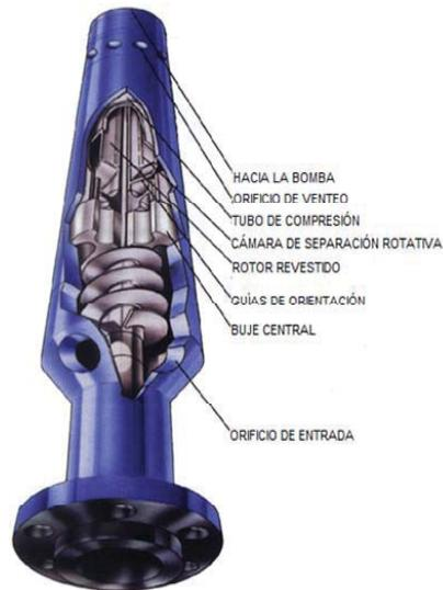
**Figura 13. Separador de gas del aparato de BEC**
