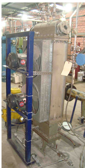
Figura 3.2. Absorbedor de película descendente en tubos verticales
