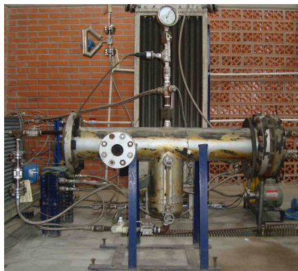
Figura 3.1. Generador de película descendente en tubos horizontales
