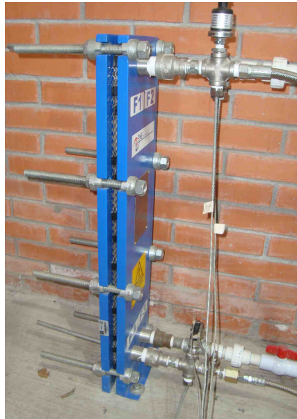
Figura 3.7. Evaporador de tipo PHE
