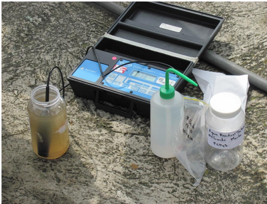
Imagen 2: Muestra de agua de la planta de tratamiento para hacer los análisis sobre las condiciones del agua de riego. Fuente: PUMAGUA (Foto: Wendy Mortera Ruenes) 19 de agosto 2010
