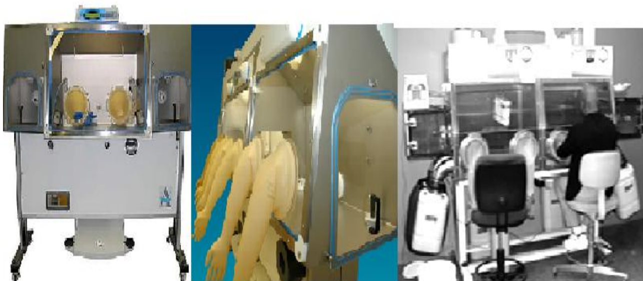
FIGURA 4. AISLADORES; GABINETES DE ALTA SEGURIDAD CLASE III.
