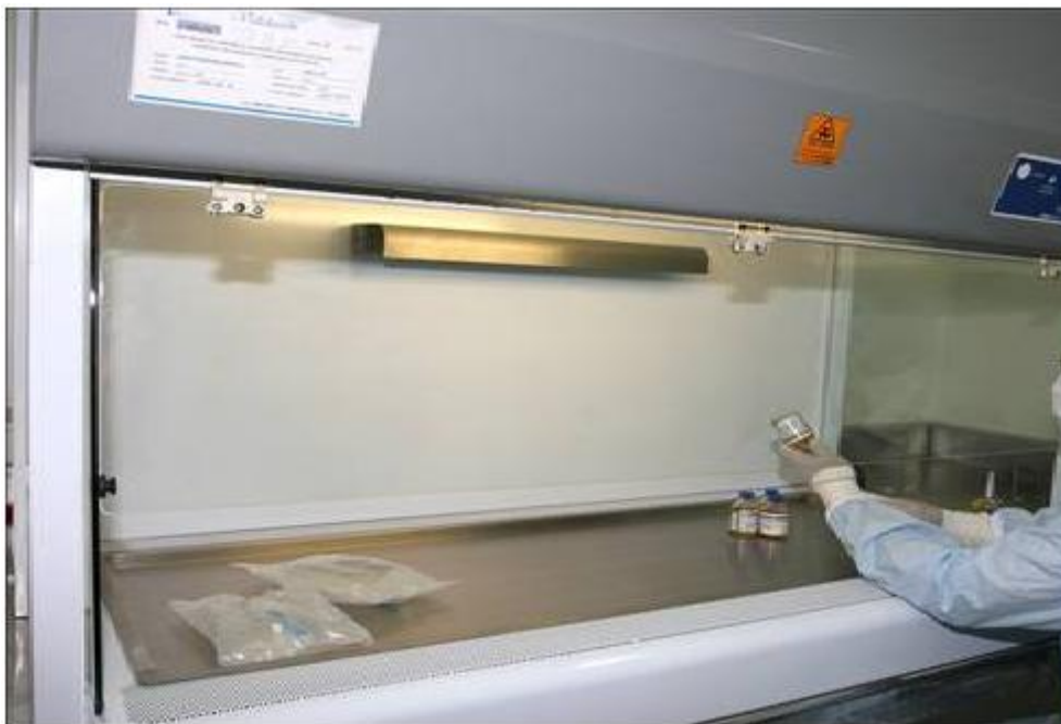
FIGURA 3. GABINETE DE SEGURIDAD TIPO IIB, UTILIZADO EN LA PREPARACIÓN DE MIV (CITOTÓXICOS Y ANTIBIÓTICOS).
