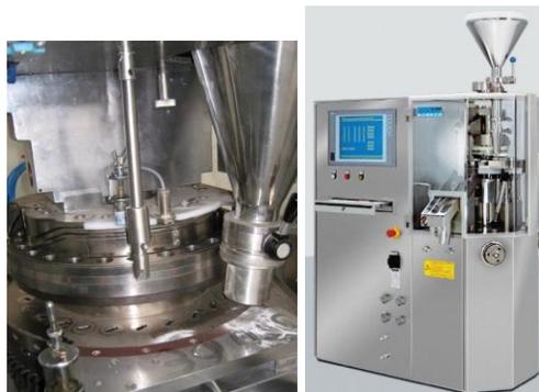
Figura 1. Tableteadora rotativa y monopunzónica. [www.kirschenhofer-ag.ch](http://www.kirschenhofer-ag.ch)
