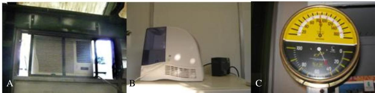
Fig.8. Equipo con el cual se mantuvo el laboratorio en condiciones controladas en cuanto a temperatura y humedad. A) Aire acondicionado, B) Humidificador y C) Higrómetro (Tomada por Ibarra, 2008).
