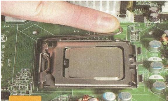
Luego de comprobar las referencias de posición, se coloca el microprocesador sobre el zocalo, bajando la cubierta y finalmente, ajustando el dispositivo, para luego descender y sujetar la palanca o guillotina.
