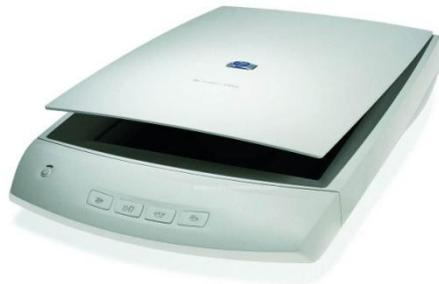
Un escáner de computadora es un periférico que se utiliza para convertir, mediante el uso de la luz, imágenes impresas o documentos a formato digital. Los escáneres pueden tener accesorios como un alimentador de hojas automático o un adaptador para diapositivas y transparencias. Al obtenerse una imagen digital se puede corregir defectos, recortar un área específica de la imagen o también digitalizar texto mediante técnicas de OCR. Estas
