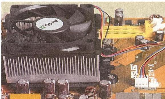
Finalmente se logra observar el microprocesador con el disipador y el cooler instalados. Las diferencias entre el ensamblaje de microprocesadores Intel y AMD son apreciables a simple vista.
