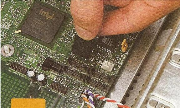
Se toma un cable Serial ATA y se conecta uno de sus extremos al conector SATA disponible en la motherboard. En este caso se observa que se cuenta con cuatro conectores SATA en la motherboard.
