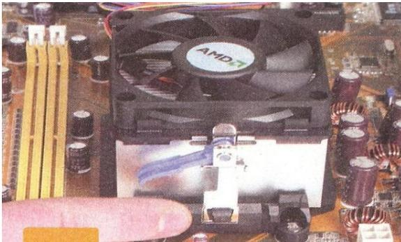
Se toma el cooler con el disipador y se coloca en la base de la motherboard, sobre el microprocesador. En este paso, es importante poner las trabas de metal sobre las de plástico, como se observa en la imagen.
