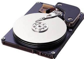
Un disco duro o disco rígido o Hard Disk Drive, HDD es un dispositivo de almacenamiento de datos no volátil que emplea un sistema de grabación magnética para almacenar datos digitales. Se compone de uno o más platos o discos rígidos, unidos por un mismo eje que gira a gran velocidad dentro de una caja metálica sellada. Sobre cada plato se sitúa un cabezal de lectura/escritura que flota sobre una delgada lámina de aire generada por la rotación de los discos.
