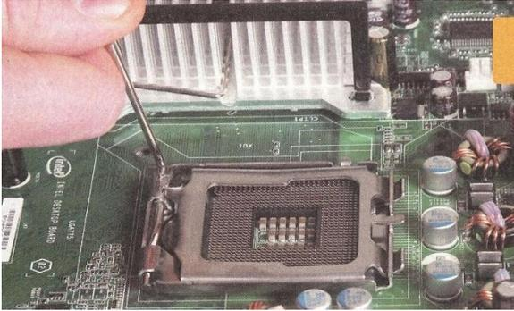
Se coloca la motherboard sobre una superficie plana. Se toma el seguro (palanca o guillotina) del zocalo y lo liberamos como se aprecia en la imagen.
