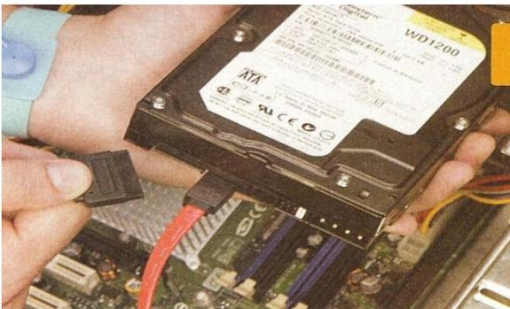
De la fuente de alimentación se toma la punta de tipo SATA y se conecta al disco duro. Para finalizar solo se coloca el disco duro en la bahía y es asegurada atornillándola.
