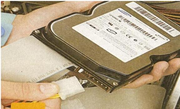
Se toma el cable con conexión Molex que provenga de la fuente de alimentación y se conecta a la unidad de disco duro. Esta punta posee también una muesca de posición, para no conectarla de manera equivocada.
