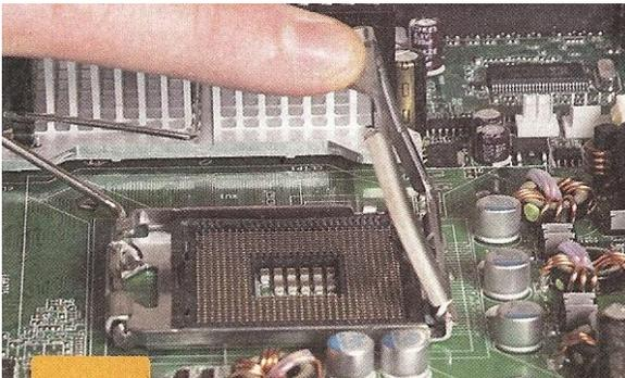
Se observa que el zocalo esta protegido por una cubierta que necesita levantarse para que los pines o contactos queden al descubierto. Cabe aclarar que no todos los modelos de zocalo poseen este diseño.
