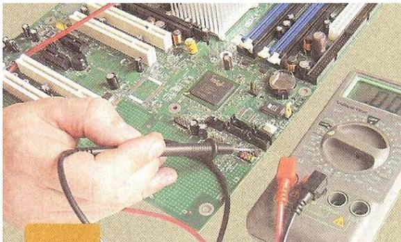
Se ubica la punta en el conector Power Switch del panel frontal. Si la pista que se esta midiendo se encuentra en optimas condiciones, el multmetro proyectara un valor de cero; de lo contrario, el resultado sera 1.
