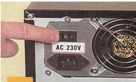
Una vez hecho el puente, se comprueba si el cooler de la fuente gira. Si no es así, se tiene que verificar el botón de encendido que tiene la fuente en la parte posterior, luego se verifican los voltajes en la salida de cada uno de los conectores.
