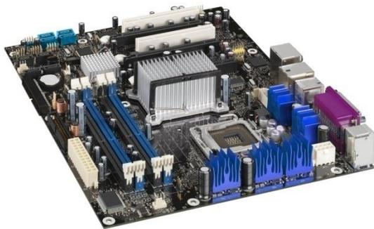
La placa madre, placa base, mainboard o motherboard en inglés, es la placa de circuitos impresos que sirve como medio de conexión entre el microprocesador, los circuitos electrónicos, los slots o ranuras para conectar la memoria RAM del sistema, la memoria ROM BIOS y otros slots que permiten la conexión de las placas de expansión adicionales.
