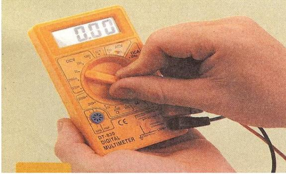
Para medir los voltajes de salida se coloca el multímetro en voltaje corriente continua, en escala de 20 V. Se selecciona esta escala por que es la mas cercana al voltaje que entrega la fuente que es de 12V.
