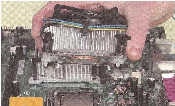
Luego se toma el conjunto disipador y cooler y lo colocamos sobre el microprocesador, verificando que las cuatro trabas coincidan con los orificios de la motherboard. Este proceso no debe de implicar ninguna complejidad ni efectuarse haciendo presión; solo se tiene que bajar el dispositivo.
