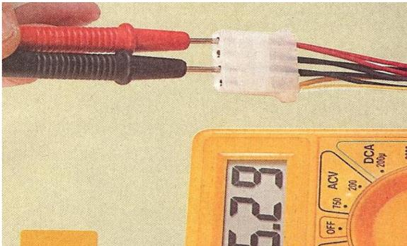
Se conecta la punta roja del multímetro en la salida del conector molex de la fuente y la otra punta en alguno de los pines de tierra. Se verifica si el voltaje de salida corresponde a 5V.
