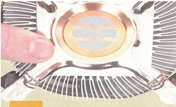
Los disipadores que Intel proporciona para sus microprocesadores tienen una base de aleación de aluminio y cobre, que permite una mejor disipación. Además, se puede observar unas líneas grises, que son porciones de paños disipadores de calor.
