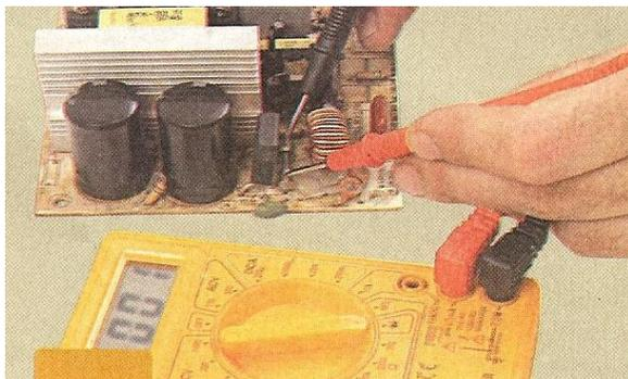
Se identifica al fusible del lado primario de la fuente, en el cual se colocara el multímetro en continuidad y se medira la resistencia producida en ambos polos. Si el fusible esta quemado, el multímetro indicara el numero uno en falta de continuidad.
