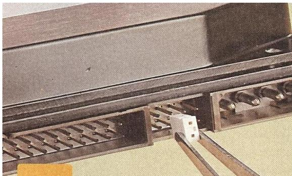
Se toma el disco duro y con unas pinzas de punta para jumpers o similar, se configura como maestro, siguiendo las instrucciones de la etiqueta del disco duro.
