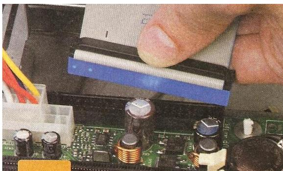
Se conecta el cable de datos al conector de 40 pines correspondiente al canal primario de la motherboard. Se observa que la punta del cable como la conexión de la motherboard tienen una muesca para que el cable ingrese de una única manera.
