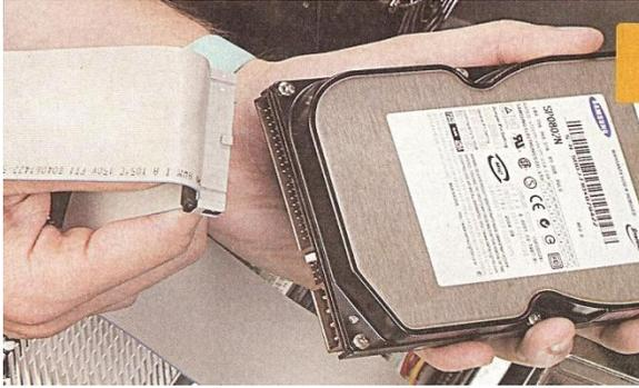
Se toma una punta del cable y se une al conector de datos del disco duro. También se observa la muesca de la conexión aun que también el hilo de color debe apuntar hacia la conexión Molex de alimentación de la unidad.
