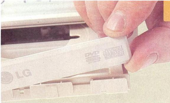
En la parte frontal del dispositivo se observa que existe un pequeño orificio por el que se puede introducir un clip y empujar ligeramente hasta lograr que la bandeja salga. Luego se retira la tapa que se encuentra en el extremo de la bandeja.
