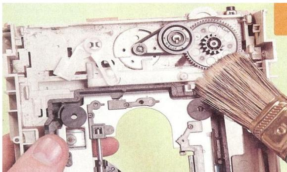
Para efectuar una buena limpieza en los dientes de los engranajes, basta con pasar una brocha de cerdas duras en sentido perpendicular a la posición del dentado y comprobar que no quede ningún objeto extraño entre las mismas.
