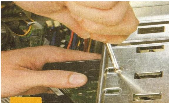
Se coloca el disco duro en una bahía interna y se asegura mediante tornillos cortos de paso grueso. Siempre es recomendable colocar cuatro tornillos por unidad, para evitar vibraciones que puedan dañar el disco.
