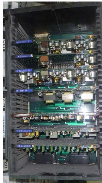
Fig. 2.13 Cartas electrónicas donde se muestran conectores, desengañadores, extractores y elementos montados sobre éstas.
