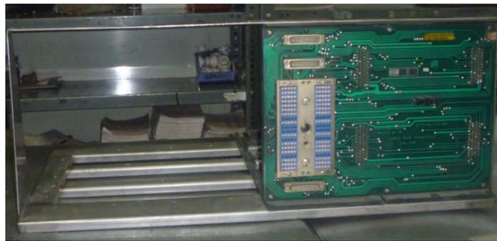
Fig. 2.12 Conjunto de cartas electrónicas ensambladas en cajón I Alimentación PA - CMC.
