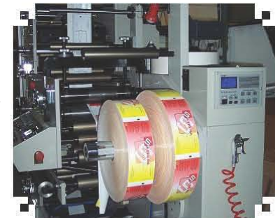
Foto 41. Flexografía. Es utilizada para la fabricación de etiquetas y envases de todo tipo.
