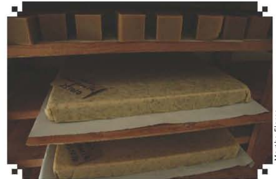
Foto 22. Barra. Se deja reposar la mezcla antes del corte final.
