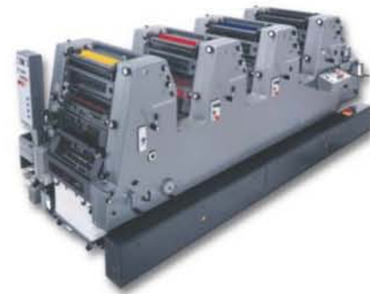
Foto 39. Máquina de Offset. Permite la impresión de grandes tirajes en poco tiempo.
