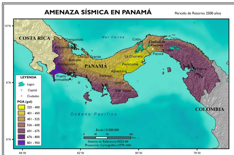
**Figura 4.17.** Aceleración máxima (PGA) para un periodo de retorno de 2,500 años (Camacho y Benito, 2010).
