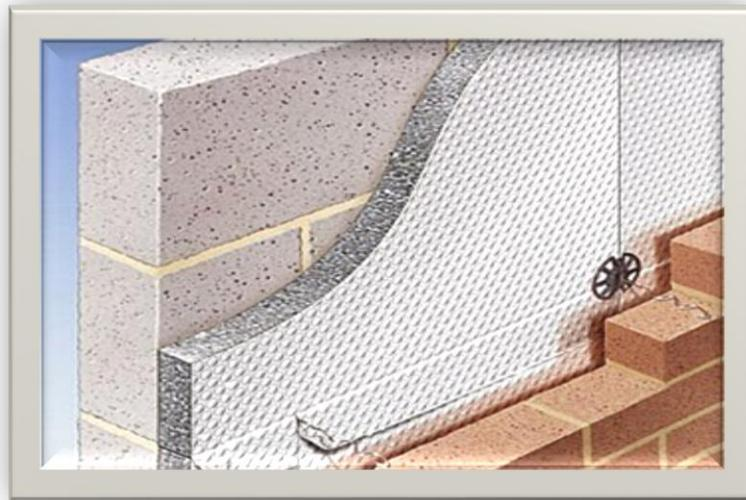
Fig.N°14 Poliestireno Expandido
