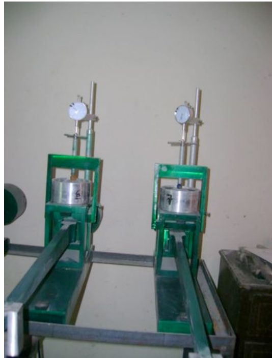
PRUEBA DE CONSOLIDACIÓN
