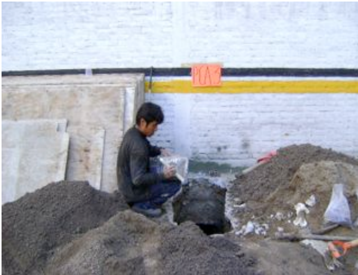
FOTO DE LA OBTENCION DE MUESTRAS CUBICAS
