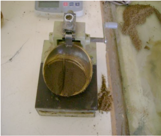
PRUEBA LIMITES DE CONSISTENCIA
