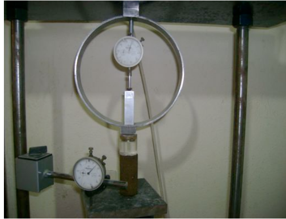
PRUEBA COMPRESIÓN SIMPLE
