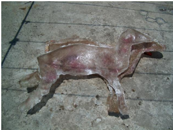
Figs. 3 y 4. Elaboración del maniquí con fibra de vidrio y espuma de poliuretano.
