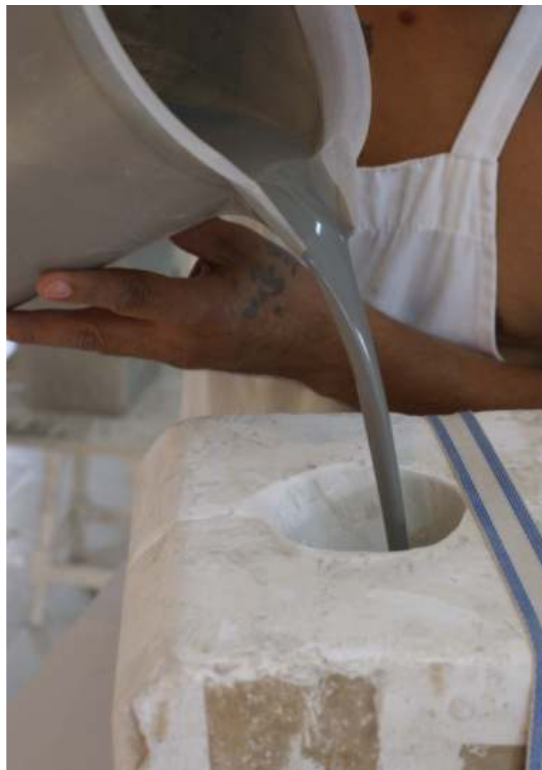
Fig.30 Foto de artesano vertiendo pasta líquida en molde de yeso.
