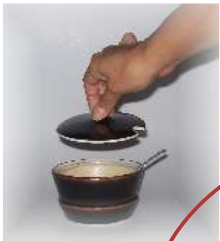
soporte para tapa generado con la cuchilla durante la fabricación en tarraja
