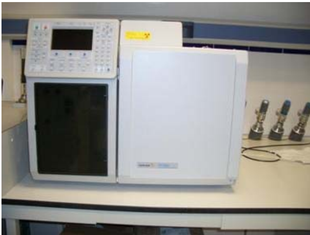
Fig. 40 fotografía del dispositivo con el que se realiza la cromatografía de gases. 67
