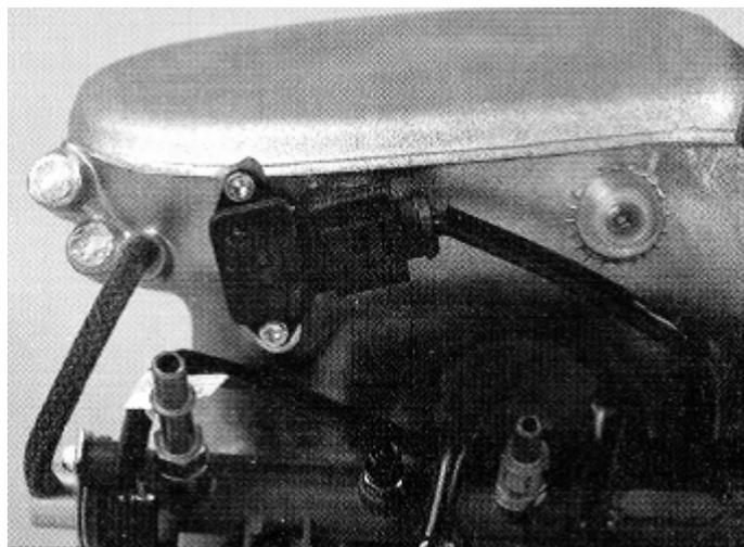
Figura 49. Colocación del sensor.
