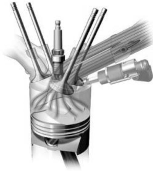
Figura 14: Sistema de inyección directa Audi FSI en cámara de combustión
