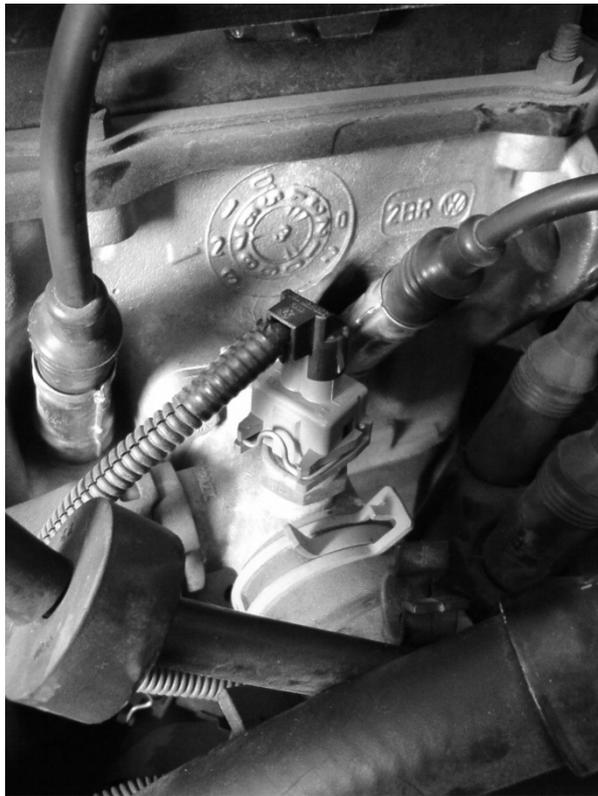
Figura 101. Sensor de temperatura del motor
