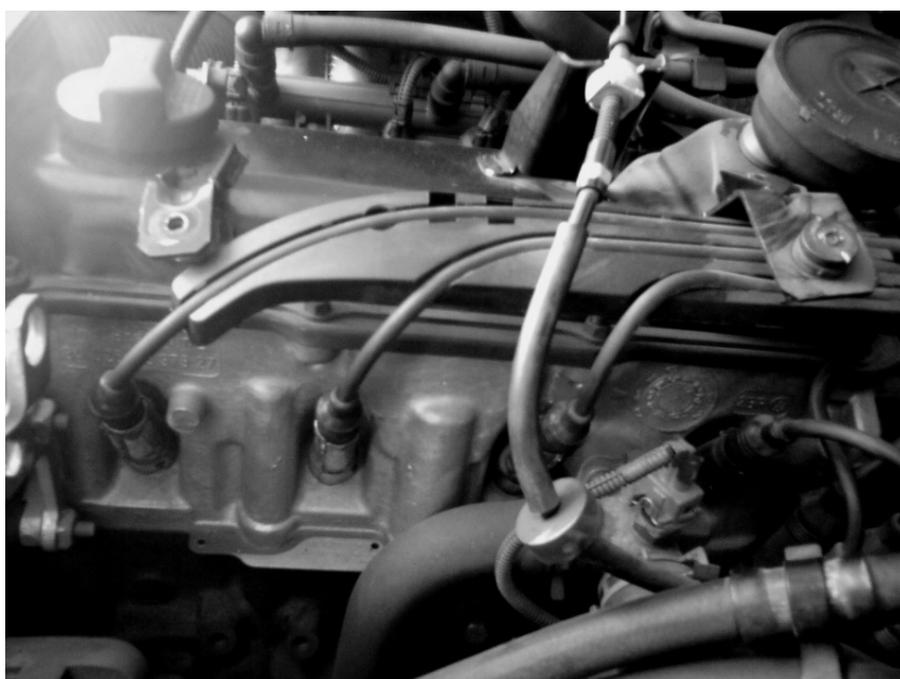
Figura 93. Bujías conectadas a la cámara de combustión.
