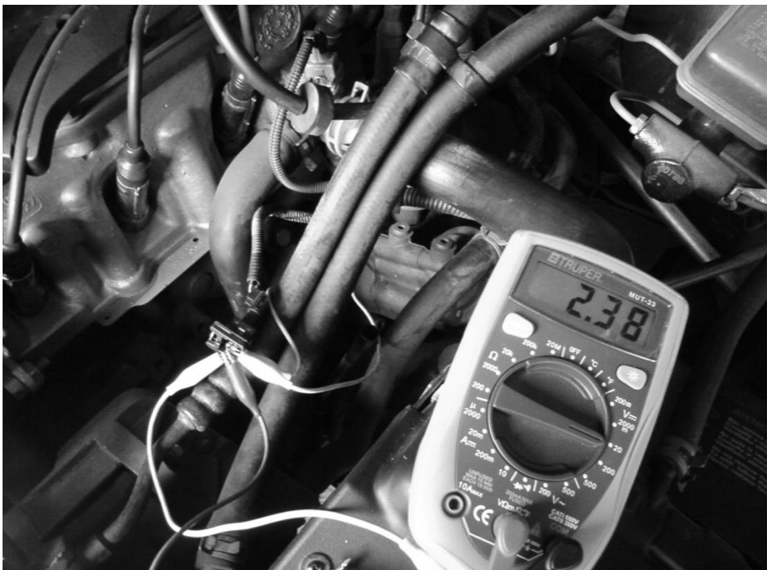
Figura 114. Conexión real en voltaje.
