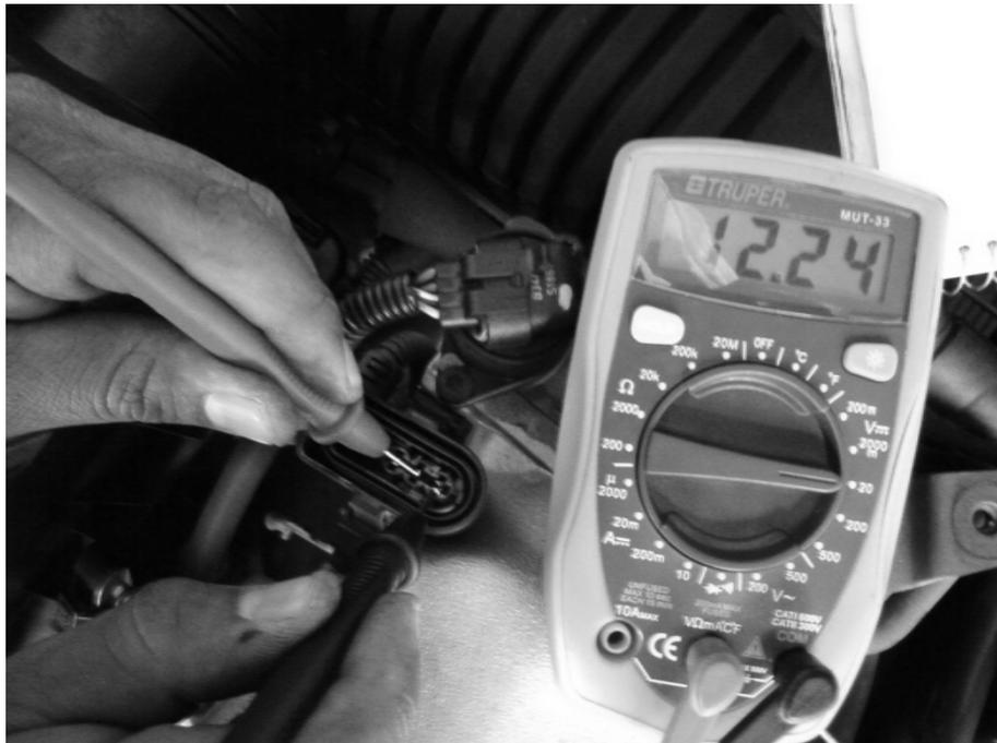
Figura 109. Prueba de voltaje al sensor Lambda
