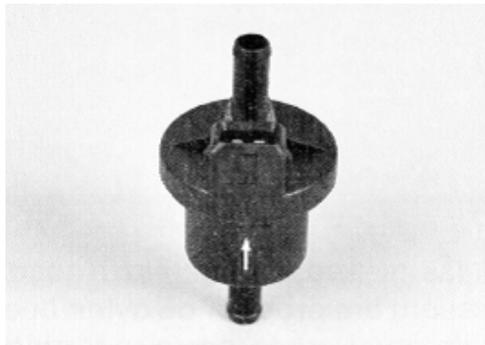
Figura 76. Filtro canister
