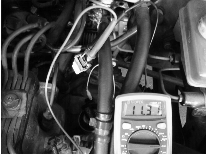
Figura 105. Prueba de voltaje del sensor.
