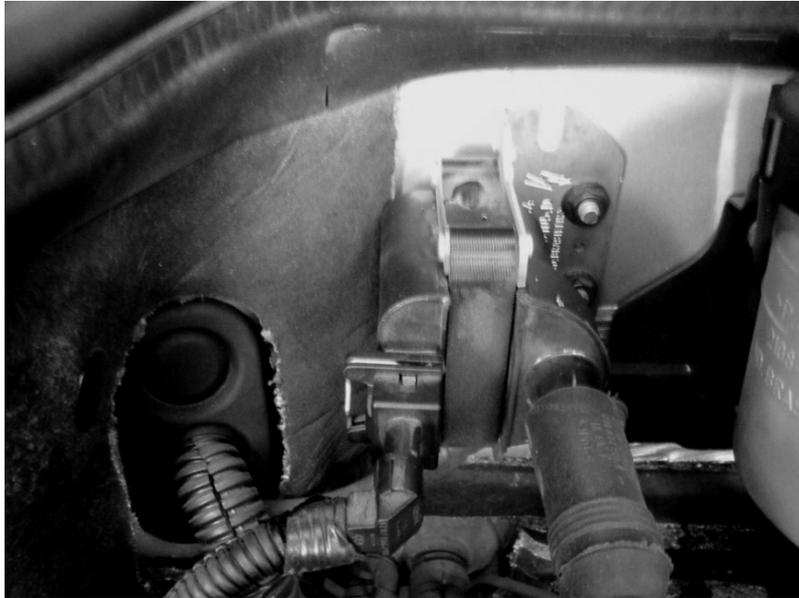
Figura 94. Bobina de sistema de inyección.
