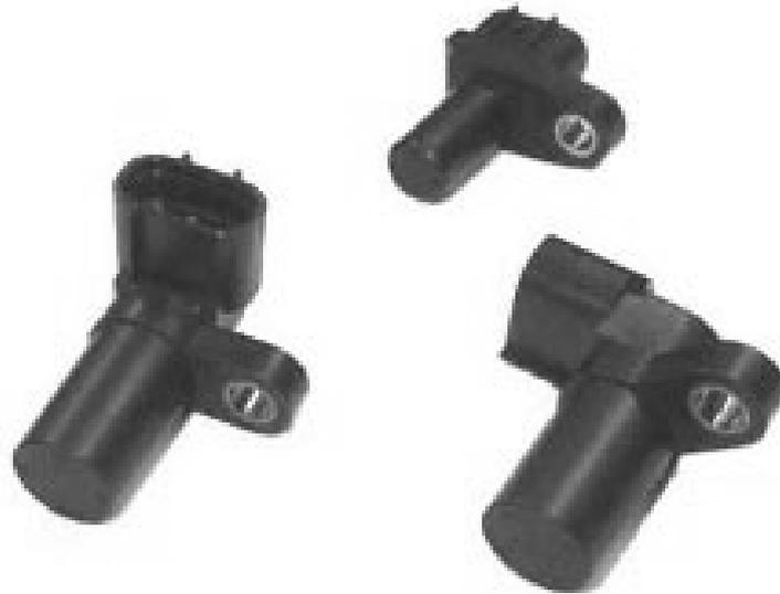
Figura 20: Sensor de posición de árbol de levas Honda C
