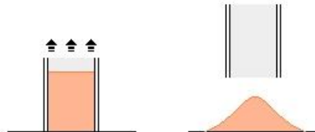
Figura No. 38. Ángulo de reposo estático.
